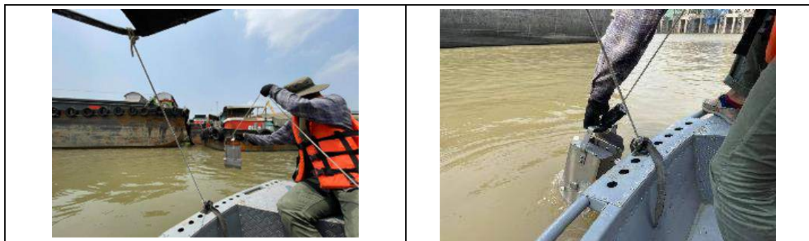
รูปที่ 3.2-56 : การเก็บตัวอย่างตะกอนพื้นท้องน้ำ
