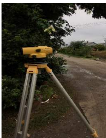
รูปที่ 3.2-42 : การสำรวจโยนค่าระดับและสอบเทียบระดับ Tide gauge
