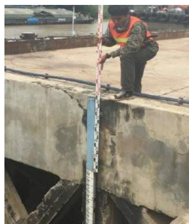
รูปที่ 3.2-42 : การสำรวจโยนค่าระดับและสอบเทียบระดับ Tide gauge
