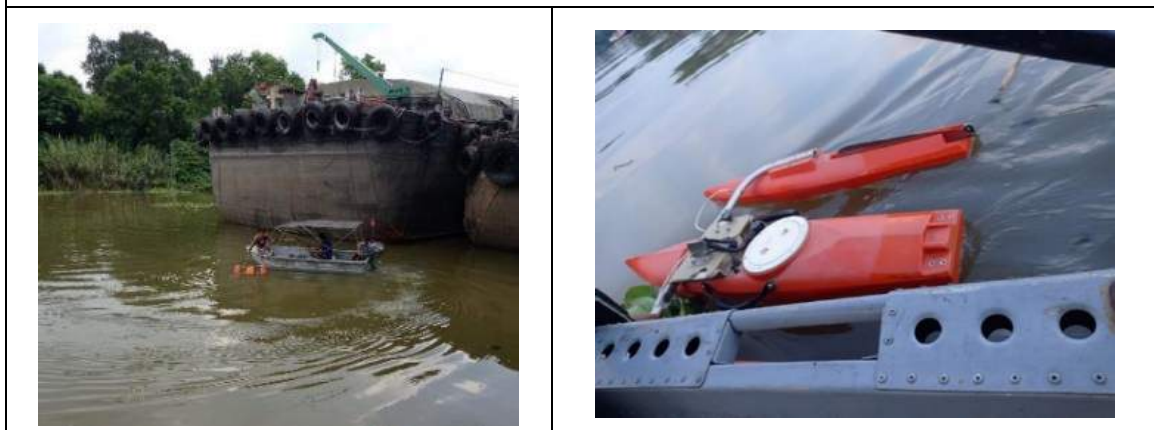
รูปที่ 3.2-47 : การใช้เรือลากเครื่องมือวัดกระแสน้ำ จากตลิ่งฝั่งหนึ่งไปยังอีกฝั่งหนึ่ง
