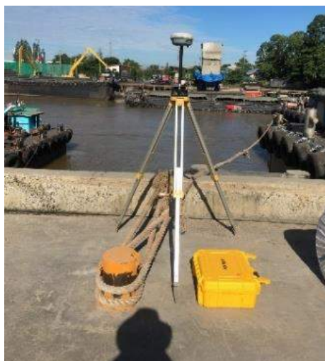
รูปที่ 3.2-41 : การสำรวจขยายหมดควบคุมในพื้นที่โครงการ
